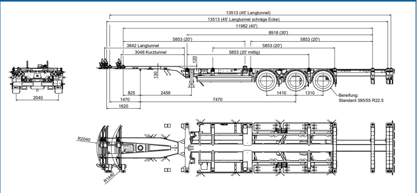
**Achtung: Der Transport von 45' Containern mit Langtunnel und abgeschragten Ecken vorne ist innerhalb der EG-Richtlinie möglich. Transport von 45' Containern mit Kurtunnel nicht möglich!**
