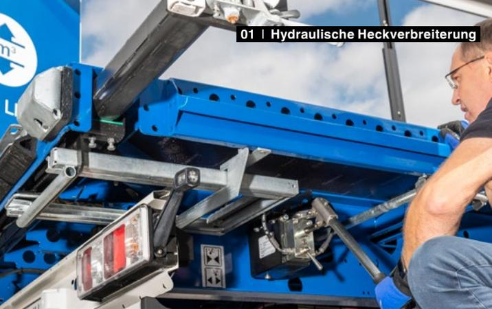
01 | Hydraulische Heckverbreiterung
