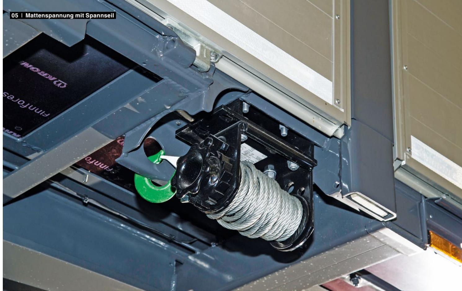
**05 Spannvorrichtung.** Je Seite verfügt das Fahrzeug über 6 Mattenspannvorrichtungen für 8 mm Spannseil oder entsprechende Spanngurte. Integriert ist je ein Schwerlastzurring je Spannvorrichtung.
