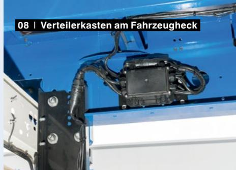
08 | Verteilerkasten am Fahrzeugheck
