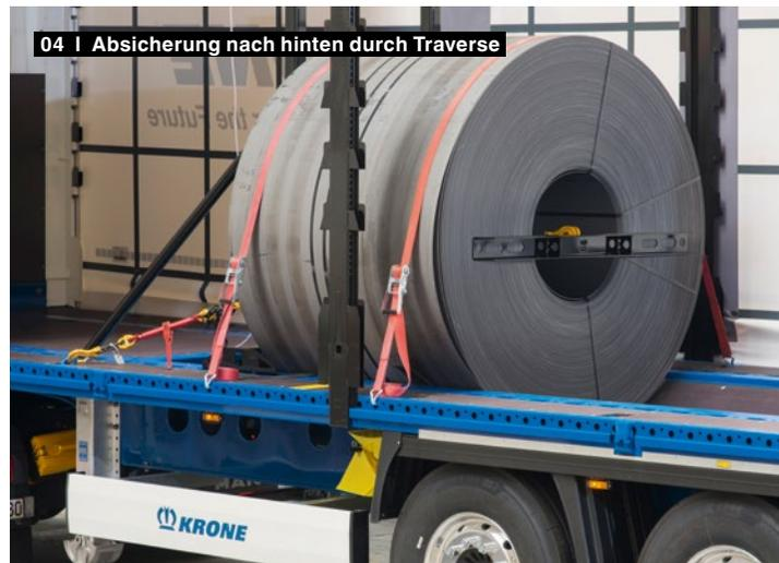
04 | Absicherung nach hinten durch Traverse
