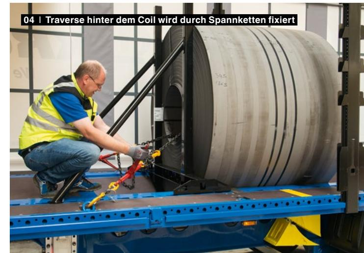
04 | Traverse hinter dem Coil wird durch Spannketten fixiert
