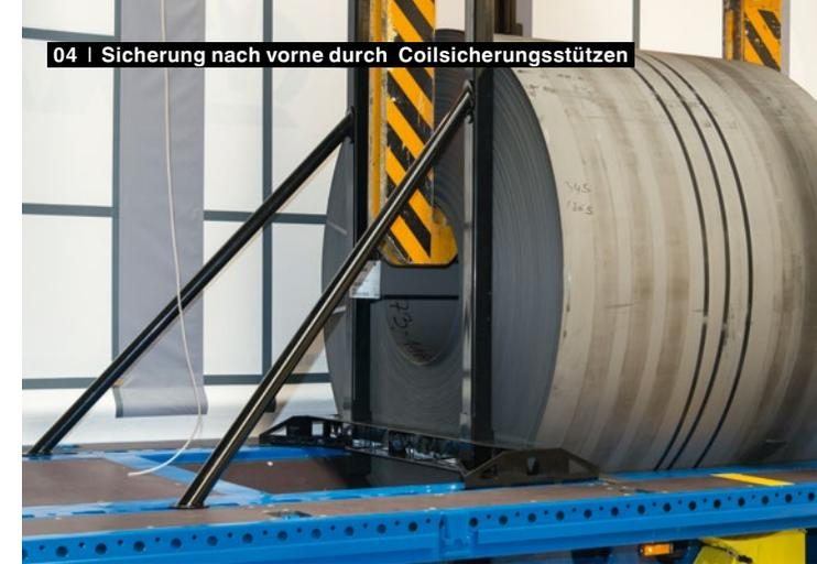
04 | Sicherung nach vorne durch Coilsicherungsstützen
