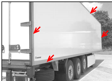
Duoplex GFK (plastic cu fibră de sticlă) (îmbinare lipită)
